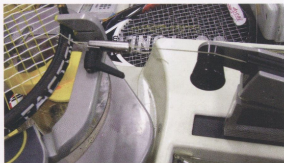
Рис. 3. Специальный зажим для натяжки короткого отрезка струны
