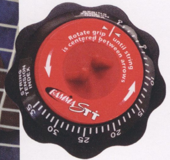
Рис. 1. Специальные приборы для измерения жесткости струнной поверхности
