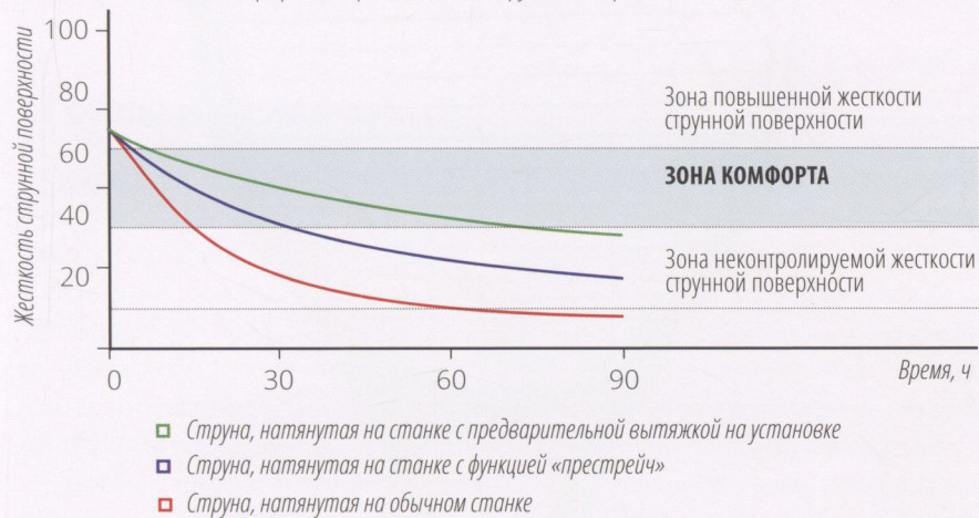
Рис. 10. График потери жесткости струнной поверхности
