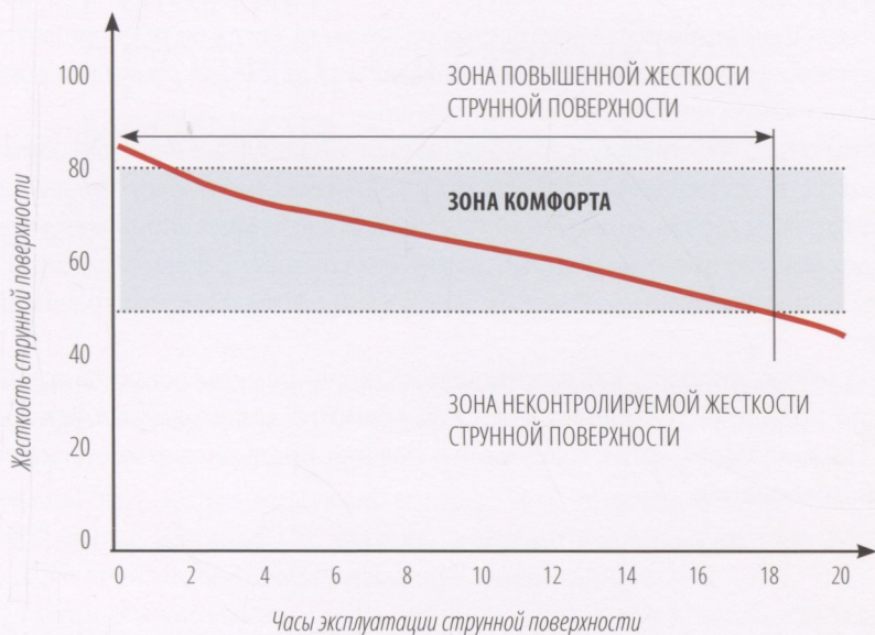
Рис. 3. График изменения жесткости струнной поверхности
