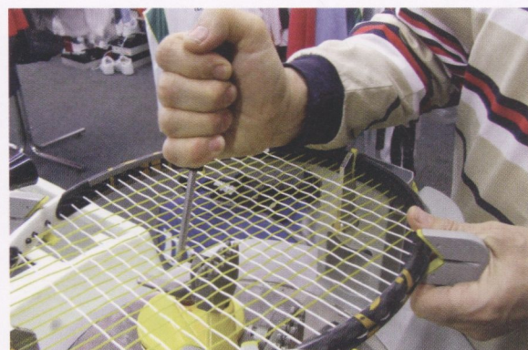
Рис. 4. Специальное толстое шило для правки струн в конце работы
