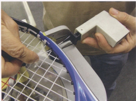
Рис. 2. «Пистолет» – вспомогательный инструмент для натяжки струны
