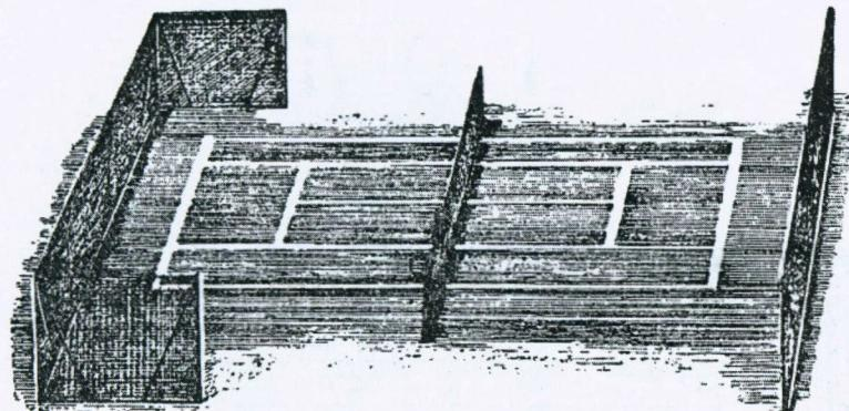
Как видно из рисунка только задних линий на одну сторону требуется 25,5 метра (35 арш.) столько же и на вторую всего  $51 \times 3$  метра ( $70 \times 4$  арш.) из проволоки № 16.
